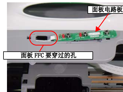
图 2-5. 面板电路板的安装
